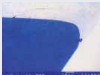
在切削1000 m针松木材后刀尖已出现明显的磨损。
