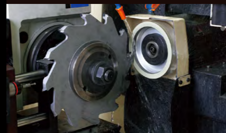
通过 Gran DIA 研磨金刚石刀具的工序
