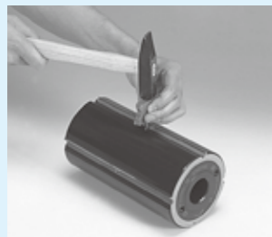
使用附带工具解除刀楔子 Tap the wedge gently
