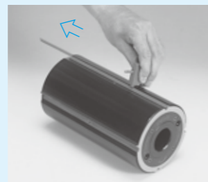
把刀片滑出 Slide the knife out
