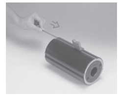
Einstellblock zwischen Spannkeil und Kopf klemmen und das Messer hineinschieben
