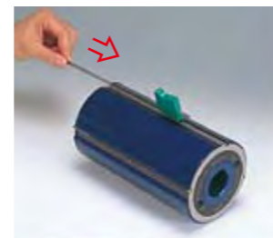
把安装夹具放入刀槽，就可容易的把替刀滑出。
